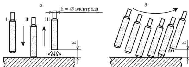
Рис. 23. Зажигание дуги: а – способом тычка; б – способом чирка
